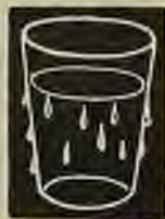
На стѣнкахъ холоднаго стакана осѣли капельки воды—охладившійся водяной паръ изъ воздуха.
